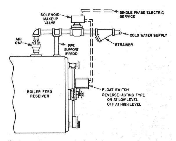
OPTION: 3 VALVE BY-PASS AROUND SOLENOID VALVE FOR MANUAL OPERATION
